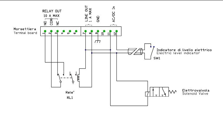
Il rele' RL1 e' eccitato quando vi e' olio nel serbatoio E il dispositivo e' alimentato. The relay RL1 is excited when the oil tank isn't empty AND the device is power supplied.
