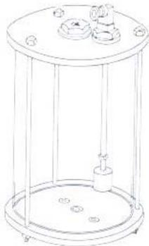
Contenitore tipo DE-3 / DE-5 - Ø 208 x 175 / 260 kg. 2,500 completo di indicatore livello elettromagnetico. Deve essere collocato sopra le elettropompe - il lubrificante alimenta le elettropompe per caduta - Il tubo di alimentazione, prima di essere collegato, **DEVE** essere completamente pieno di lubrificante.
