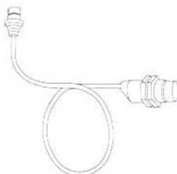
Rivelatore tipo Namur Ø 18 deve essere collocato alla distanza di mm 5 dal perno che, al suo passaggio, darà l'inserzione per il funzionamento immediato dell'elettropompa.
