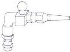
Ugello con valvola di ritegno "DG008" NON REGOLABILE deve essere collocato e orientato sul punto da lubrificare. Gli ugelli vengono forniti già collegati alla elettropompa. Lunghezza tubo mm 600.
